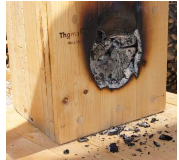
nach 150min. mit 900°C Beflammung
