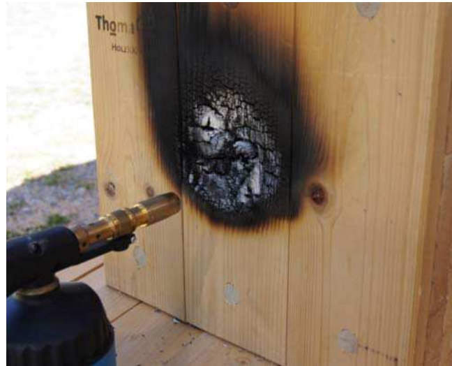
nach 60min. mit 900°C Beflammung
